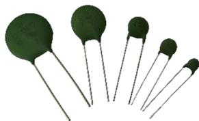
君耀电子自主研发生产多个系列的高温压敏电阻, 工作温度可达125 $^{\circ}$ C, 质量稳定, 型号齐全, 产品满足UL、CUL、TUV认证。高温压敏电阻可应用于工业电源、照明电源、通信电源、家电等环境温度较高的应用场合。目前我们可提供的高温MOV银片直径尺寸规格有5mm, 7mm, 10mm, 14mm, 20mm, 电压范可达18V~1800V。
