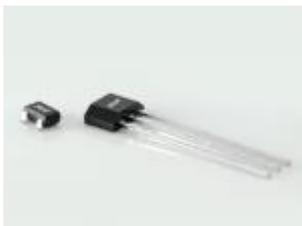
MMS2X1H是一款集成了隧道磁阻 (TMR) 传感器和CMOS技术的全极性开关, 全时供电下业界最低的1.5uA超低功耗, >1KHz频响, 采用SOT23和TO-92封装形式。
