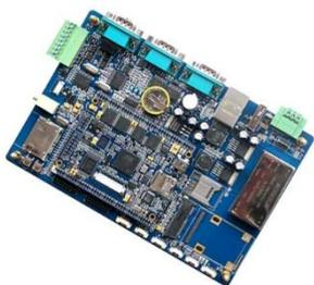
此款工业单板机是深圳市英蓓特科技有限公司基于Atmel AT91SAM9G45工业级处理器推出的一款ARM嵌入式工控应用单板机。SBC6045板载256MB DDR2 SDRAM、256MB NANDFlash、4MB DataFlash,扩展出了5路RS232串口(2路RS485/RS232复用)、2路CAN接口、网口、高速USB Host、USB OTG、SD/MMC接口、TF卡接口、Audio Out、JTAG调试等接口。产品完全按照工业标准设计,可在-40 $^{\circ}$ C~85 $^{\circ}$ C宽温温度范围内稳定工作,满足工业级产品的各种应用需求,在工业控制、现场通讯、数据采集分析、仪器仪表等各种领域得到广泛应用。
