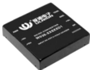
典型性能：宽范围输入 (2:1 or 4:1)；转换效率典型85%；；开关频率 300 KHz；过流、短路保护，自动恢复；输入与输出高隔离；PCB板上直插式安装；金属外壳，输出波纹低 封装尺寸：76.20×76.20×12.70mm 详情请访问我们的网站：<http://www.aipu-elec.com>
