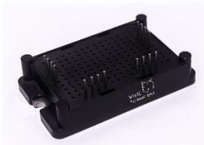
基于GaN技术的智能半桥功率模组。该模组集成了两颗GaN 晶体管、驱动及温度、电流传感器于一个封装内部。内部应用了专利的VisiC创新技术。其中使用了高功率密度平面工艺的功率GaN晶体管，具有快速的开关性能及低内阻的特性。特别适用于高频、高效、集成以及高功率密度。
