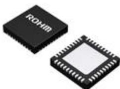
BD57020MWV是无线供电发送用IC。该元器件由线圈驱动用逆变器、Qi标准的通信包用控制器和解调电路、GPIO、TCXO缓冲器、<sup>2</sup>接口构成。通过与通用微控制器组合使用，作为符合Qi标准的无线供电的通信控制器而工作。BD57020MWV支持基于WPC Qi标准Ver.1.2 (Low Power, Medium Power) 的应用。
