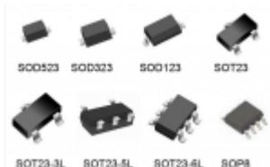
SOD、SOT、SOP类封装形式半导体电子零件，包括二极管、三极管、LED驱动、电源管理等产品，广泛应用于仪器仪表、电子玩具、家用照明、数码消费等产品上。
