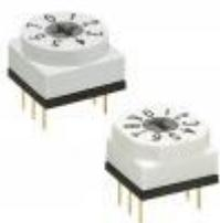
旋转编码开关准确名称是BCD Code(Binary Coded Decimal Code: 2进制, 10进制码, 8421码) 开关 通过旋转的方式, 接到的信号往其他接触点传达, 各编码会受到通过特定装置输出的信号. 可以设定标准编码或特别编码. 旋转开关应用在巴士系统, 且广泛应用与工业控制设备, 自动化设备, 智能控制, 其他控制类
