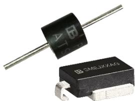
ATS系列为P600封装的大功率TVS, 10/1000 $\mu$ s瞬态功率为10kW及以上, 与传统的5kW及15kW等大功率器件封装兼容, 采用特殊的结构设计和材料搭配, 具有较好的散热性及可靠性, 产品通过了AEC-Q101测试验证, 主要推荐应用于汽车电子抛负载防护, 性价比高。
