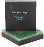
ALL-Switch 系统内嵌型开关器件。应用了VisiC创新的Smart GaN拓扑技术，该器件可以做到安全的正常情况为断开状态的器件。ALLSwitch 的V80N65B是一颗具有专利技术的高功率密度平面工艺的GaN功率晶体管，先进的封装工艺带来了超低内阻，快速的开关速度以及较小的封装尺寸。特别适用于要求高效率，高功率，低成本的应用场合。特有的启动电路会在系统启动/关断时通过检测驱动信号和供电电压来保证系统操作时序。在正常工作时，它不会对GaN晶体管的开关性能造成影响。
