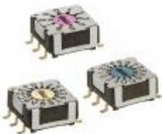
旋转编码开关准确名称是BCD Code(Binary Coded Decimal Code: 2进制, 10进制码, 8421码) 开关 通过旋转的方式, 接到的信号往其他接触点传达, 各编码会受到通过特定装置输出的信号. 可以设定标准编码或特别编码. 旋转开关应用在巴士系统, 且广泛应用与工业控制设备, 自动化设备, 智能控制, 其他控制类
