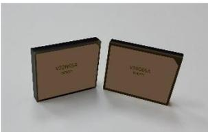
ALL-Switch 系统内嵌型开关器件。应用了VisiC创新的Smart GaN拓扑技术，该器件可以做到安全的正常情况为断开状态的器件。ALLSwitch 的V22N65A是一颗具有专利技术的高功率密度平面工艺的GaN功率晶体管，先进的封装工艺带来了超低内阻，快速的开关速度以及较小的封装尺寸。特别适用于要求高效率，高功率，低成本的应用场合。特有的启动电路会在系统启动/关断时通过检测驱动信号和供电电压来保证系统操作时序。在正常工作时，它不会对GaN晶体管的开关性能造成影响。
