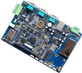
此款工业单板机是深圳市英蓓特科技有限公司基于Atmel AT91SAM9G45工业级处理器推出的一款ARM嵌入式工控应用单板机。SBC6045板载256MB DDR2 SDRAM、256MB NANDFlash、4MB DataFlash, 扩展出了5路RS232串口(2路RS485/RS232复用)、2路CAN接口、网口、高速USB Host、USB OTG、SD/MMC接口、TF卡接口、Audio Out、JTAG调试等接口。产品完全按照工业标准设计,可在-40°C~85°C宽温温度范围内稳定工作,满足工业级产品的各种应用需求,在工业控制、现场通讯、数据采集分析、仪器仪表等各种领域得到广泛应用。
