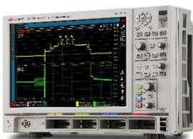
CX3300 系列器件电流波形分析仪的主机可以捕获电流传感器测得的电流波形。它的最大带宽可达 200 MHz，最大采样率高达 1 GSa/s。用户可以从前面板选择“高速模式”或“高分辨率模式”，分别以 14 位或 16 位分辨率实施数据采集。为了保持电流传感器的低噪声电流感应能力，该主机还在设计中尽量降低了噪声，即使在如此宽的测量带宽下也不例外。
